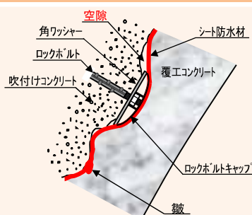
一般工法による覆工背面
